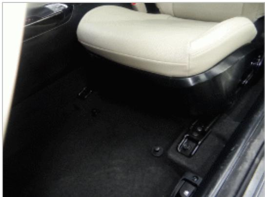
3. 拆卸前座椅后固定盖 (A), 拧下固定螺栓 (B)。
